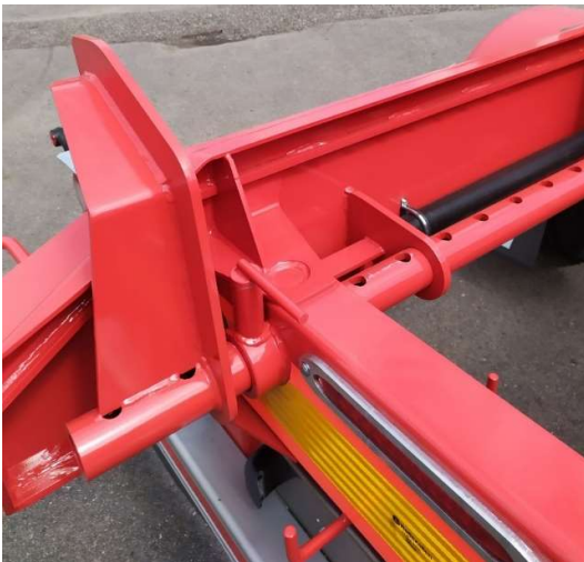
Kuva 3: Vastelevy ja sen säätövipu. Kuvassa vastelevy on yläasennossa.
