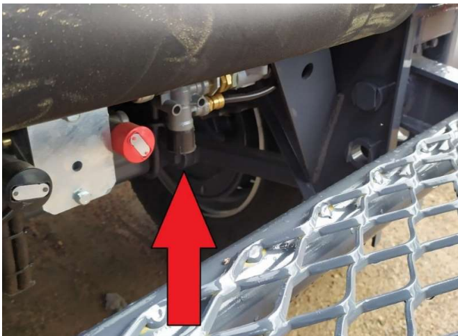
Kuva 1: Venttiilit vaunun etuosassa, nuoli osoittaa siirtelyventtiilin.
